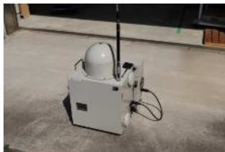
可搬型モニタリングポスト 【6台】 (バッテリー付)
