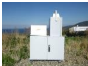
可搬式モニタリングポスト【9台】 (衛星系回線による通信機能付)
