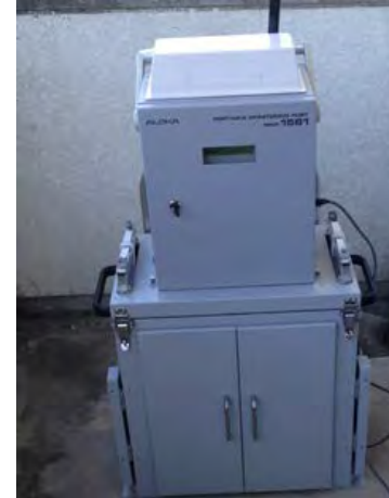
可搬型モニタリングポスト【1台】
