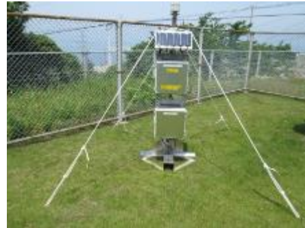
可搬型代替モニタ【5台】、可搬型モニタ【4台】 (無線による通信機能付)
