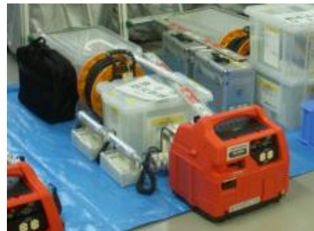
モニタリング資機材例 (サーバイメータ、非常用電源等)
