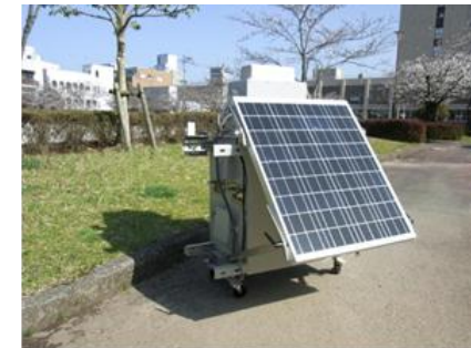
可搬型モニタリングポスト (ソーラ発電装備, 携帯電話通信機能付)
