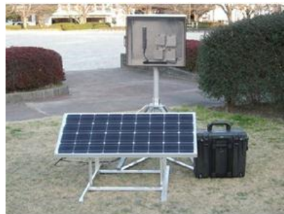
GPS追従型線量率測定装置
