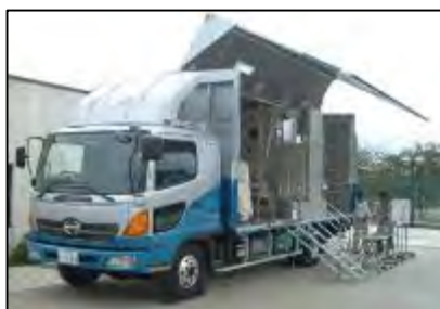
移動式体表面測定車(2台)
