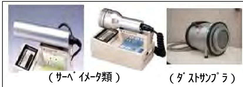
車両に搭載する可搬型放射能測定装置の例
