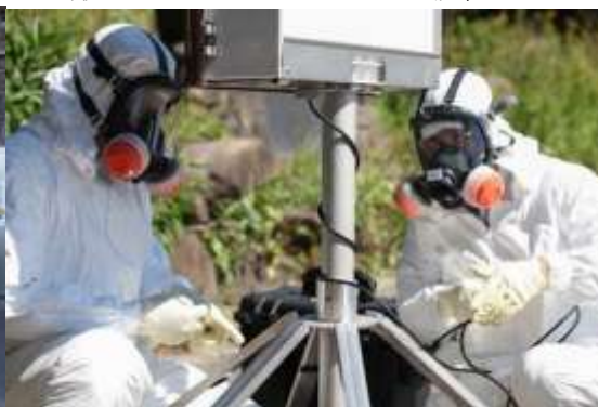
可搬型モニタリングポストの設置
