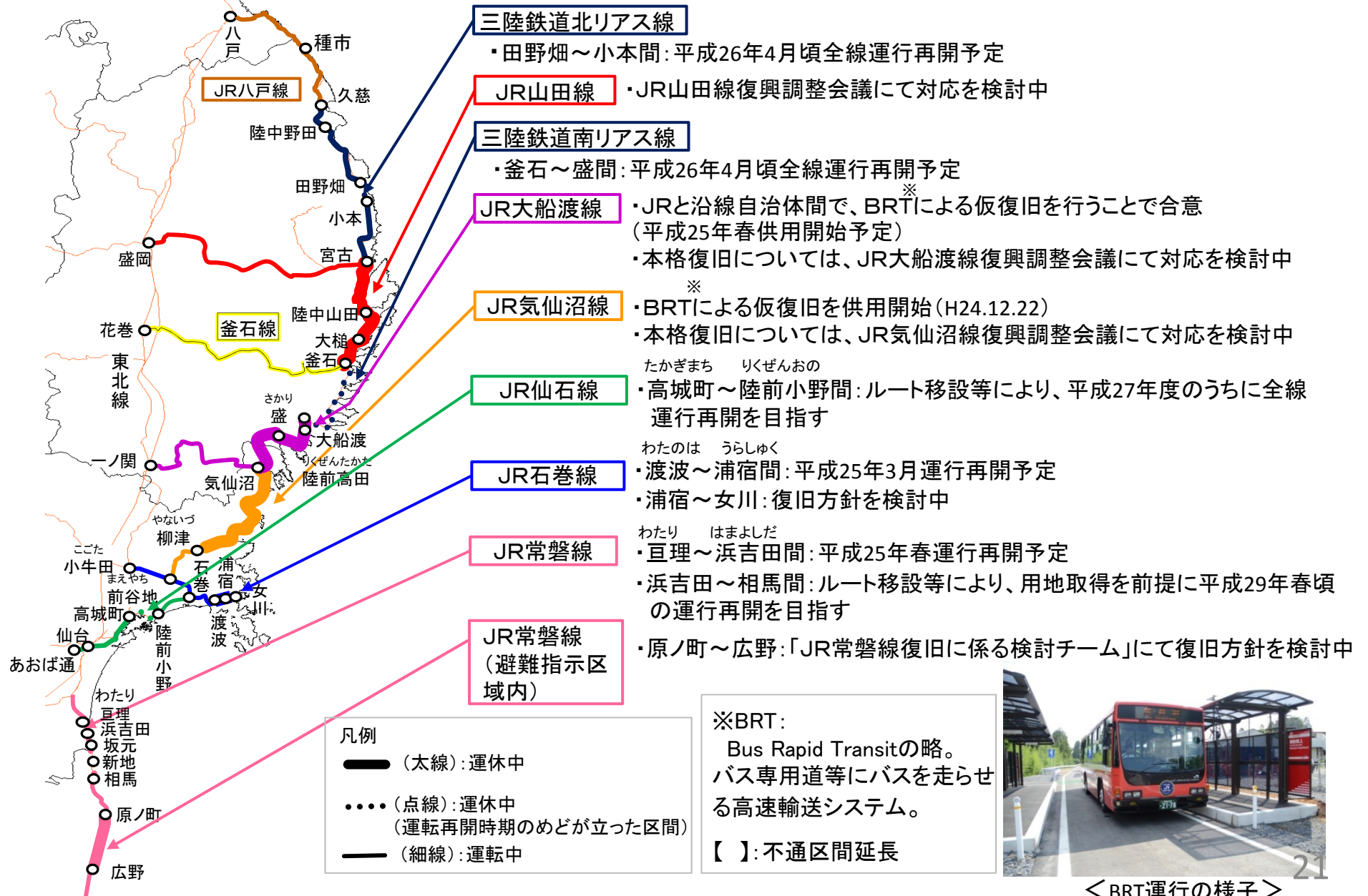
【沿岸部のJR東日本の路線の復旧状況(H25.1.3時点)】
