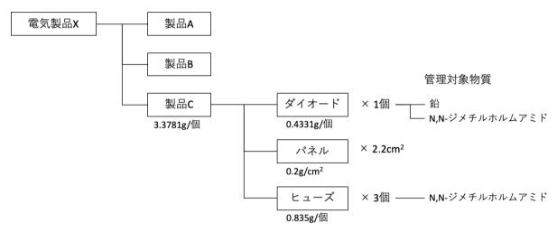
ダイオード、パネル、ヒューズの部品は川上企業から提供された原材料に基づき、川中企業が製造する。さらに次の川中企業はダイオード 1 個、パネル 2.  $2 \text{ cm}^2$ 、ヒューズ 3 個から構成される製品 C を製造する。製品 C A、C は川中企業が製造するが、ここでは管理対象化学物質を含まないとする。川下企業はこれらの製品 C A、C から最終セットアップを行い、電気製品 C を製造する。
