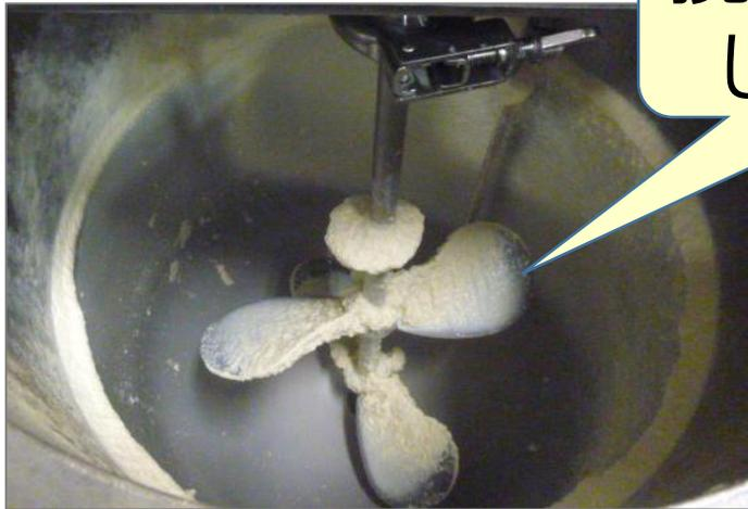
攪拌機に付着した凝固物
