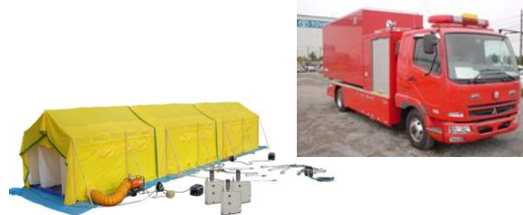
大型除染システム搭載車
